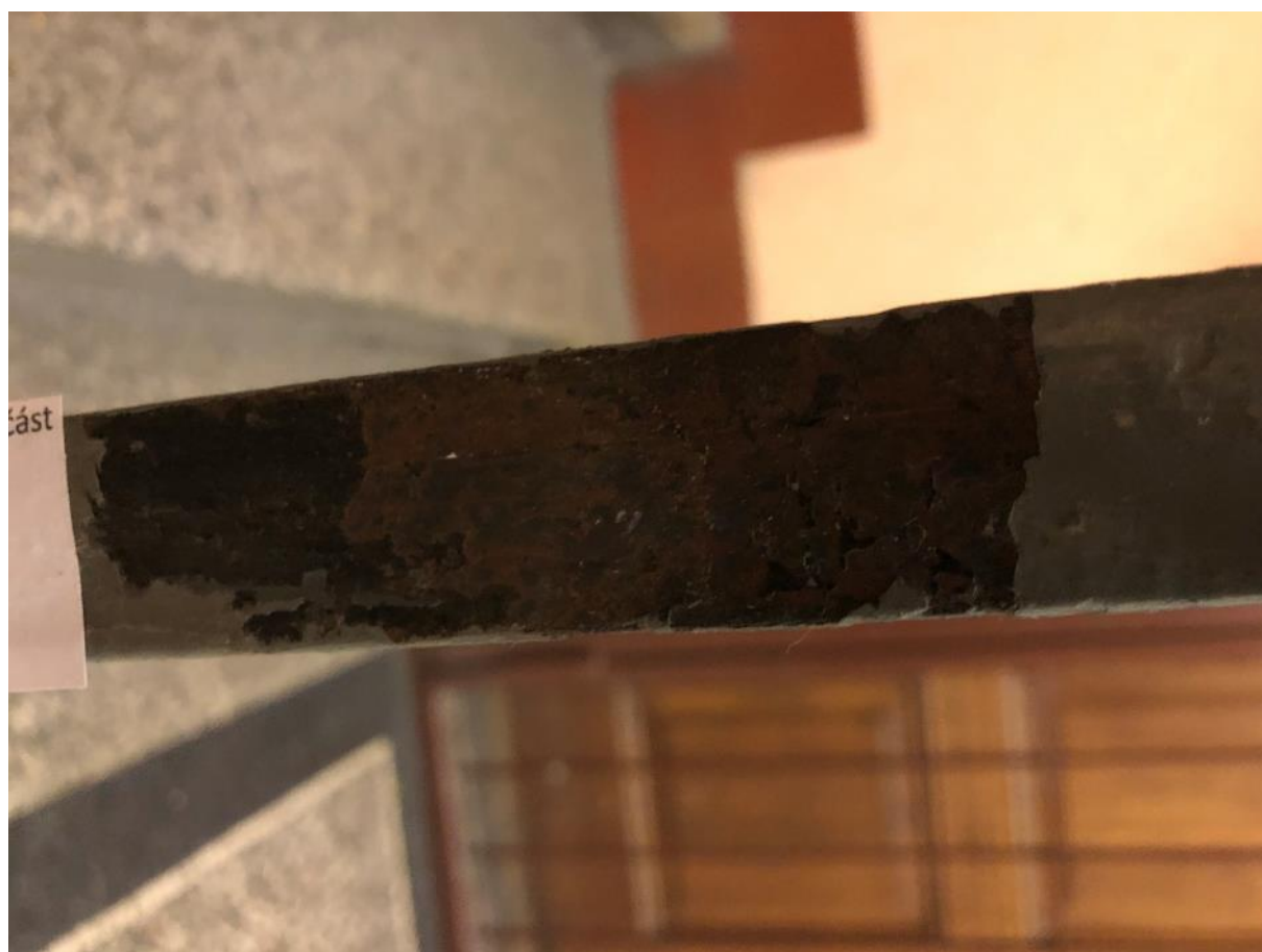
Průzkum barevnosti vrstev nátěrů
